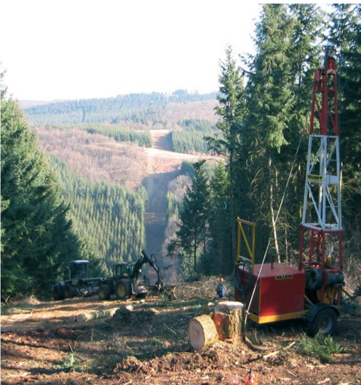
In extremen Steillagen wird die Flächenräumung mit Hilfe einer Seilschlepper durchgeführt.
