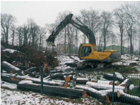
Volvo-Kettenbagger mit Roderechen zum Lösen der Wurzeln aus dem Boden
